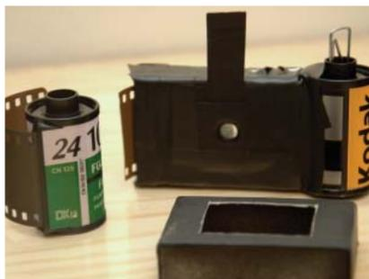
Pinhole é um processo alternativo de se fazer fotografia sem a necessidade do uso de equipamentos convencionais. Uma máquina artesanal que pode ser construída facilmente utilizando-se materiais simples e de poucos elementos. A imagem produzida numa pinhole apresenta uma profundidade de campo quase infinita, ou seja, tem um foco suave em todos os planos da cena, tudo está focado.
